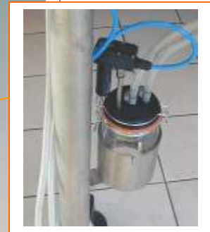
Bocal de trop-plein avec pompe à vide
