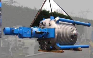
Unité d'extraction aqueuse avec concentration sous vide et pasteurisation
